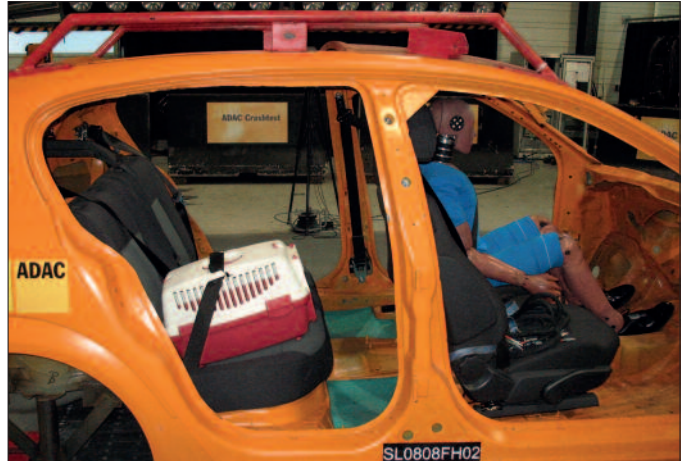
Crashtest mit gesicherter Hundebox.
